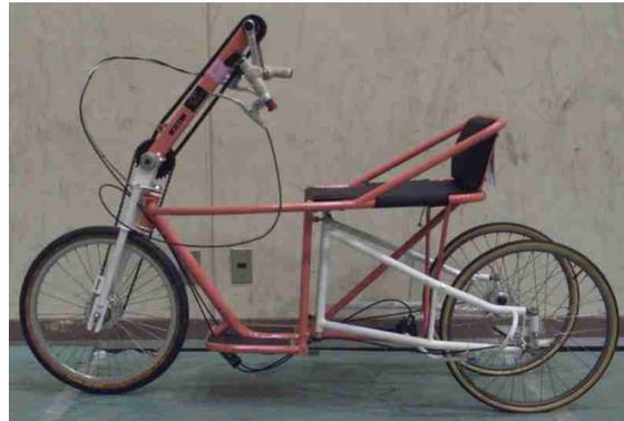
前進する。右手のブレーキレバーの位置に、後輪を左右に固定しているピンを解除するレバーがあり、これを引くと、後輪の幅が狭まり折りたたむことができるようになっている。低速時にブレーキだと思って引いてしまうと転倒する危険がある。
